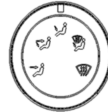
(کلید کنترل مسیر توزیع هوا)
